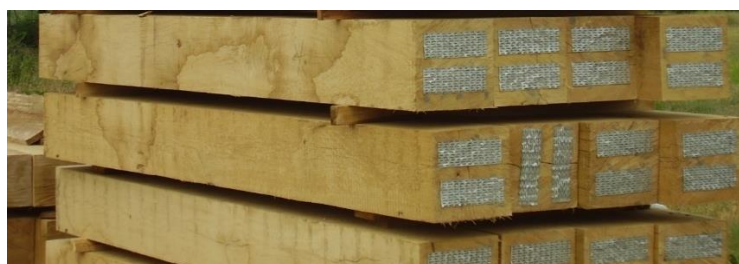
Rys. 8. Zabezpieczenia czoł podkładów przed pękaniem
