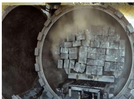
Rys. 10. Cylinder impregnacyjny stosowany przy nasycaniu materiału drzewnego metodą Rüpinga (źródło: opracowanie własne)
