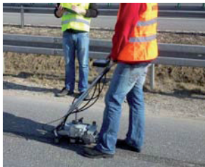
Rys. 4. Widok miernika tarcia \mu -PW; a) przyrząd w stanie złożenia, gotowy do transportu; b) widok próbki gumowej współpracującej z podłożem podczas pomiaru; c) przyrząd w trakcie pomiarów drogowych; d) widok panelu sterowania miernika tarcia \mu -PW (1- przycisk samotestowania; 2- przycisk włączenia/wyłączenia, 3- przycisk wyboru trybu pomiaru; 4- przycisk inicjowania połączenia bezprzewodowego z komputerem; 5- obszar kontroli prędkości przemieszczania podczas pomiaru; 6- przycisk startowania/zatrzymania pomiaru; 7- wyświetlacz cyfrowy)
