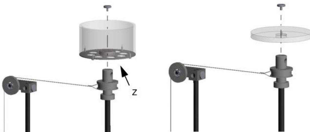
Rys. 4. Instalacja pełnego i wydrążonego walca
