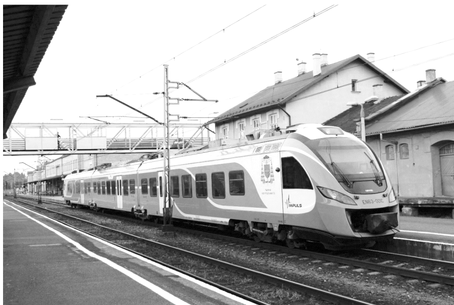
Rys. 3. Widok elektrycznego zespołu trakcyjnego serii EN63 wykorzystywanego do obsługi połączenia Rzeszów - Przemyśl
