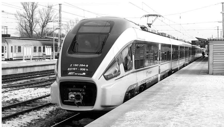
Rys. 2. Widok elektrycznego zespołu trakcyjnego serii ED161 wykorzystywanego do realizacji połączeń kolejowych z Warszawy do Białegostoku i Lublina
