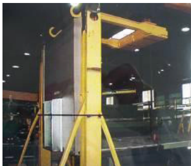
Rys. 2. Test szwedzki ściany przedniej naczepy ciężarowej – metoda dynamiczna (źródło: www.dekra.com )
