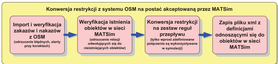
Rys. 7. Algorytm konwersji restrykcji OSM na format dla systemu MATSim. Źródło: Opracowanie własne.
